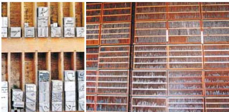
大小二十六文字のアルファベットと異なって、日本語は文字の数だけ活字が必要。右の活字棚から拾って文選箱へ
