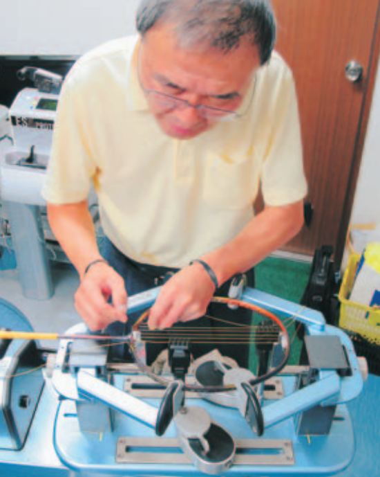
機械にラケットを固定し縦横とガットを張っていく。テンションは自動で設定。写真は、十五ポンドを示している一本張り上げのおよそ二十分
