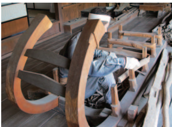
左上の馬車の車輪作りと右の橋の台木の鼻曲げの共通点は木材をセイロウでふかし、軟らかくして曲げること。高度な技術を要した
