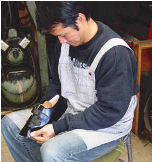
縫い終わった靴の上部を木型にかぶせ、釘と針で中敷に固定していく
