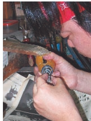
細工した跡が残らないように磨き上げる
