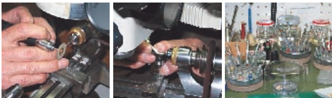
顕微鏡をのぞきながら、100分の1ミリ単位の旋盤作業に集中する佐藤洋さん この旋盤でドライバー（右端）、ピンセットまで自作
