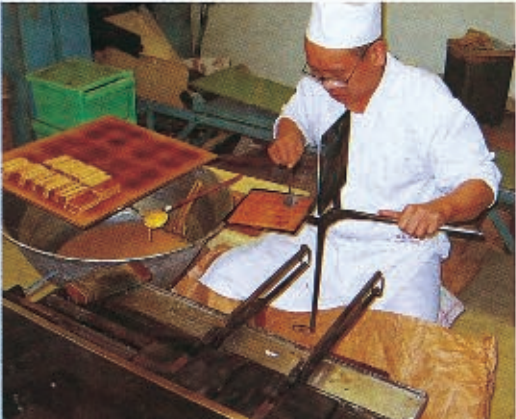
手焼きはここだけ。型に入れてガスで焼き上げる
